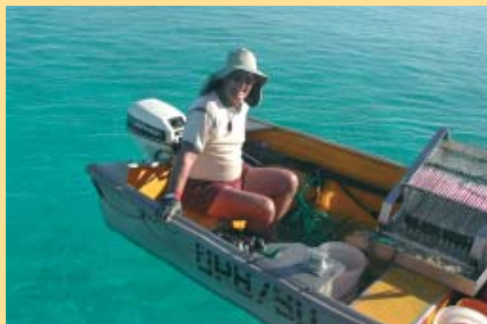
Malcolm dans son doris. On distingue la drague, posée dans le panier de tri, et le petit treuil qui lui permet de la remonter sans effort.
