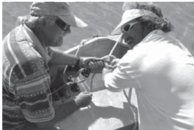
Charlie et Ron doivent raccourcir le câble de la drague pour pouvoir draguer dans des eaux moins profondes.
