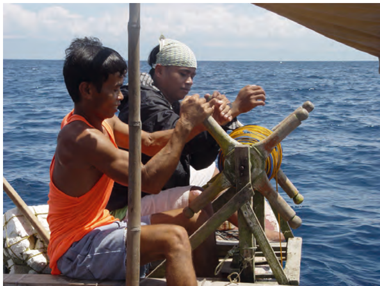
Cabestan permettant de relever le filet
