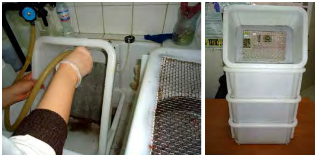
Figure 2 : Ensemble des tamis de mailles différentes utilisés pour la séparation de la faune de l'échantillon du sédiment par taille
