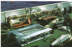
Un assortiment d'engins sur le pont du «Jean Charcot»: au premier plan, la drague Sanders; à droite une petite drague à roche, au fond le chariot à perche de 4,5 m d'ouverture
