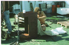
Le lourde drague à roches en train d'être grée. Il faudra ensuite monter des protections en cuir qui éviteront que le filet ne se déchire
